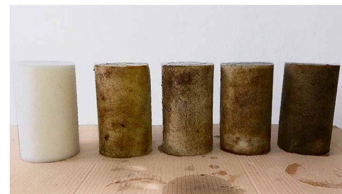
Molche, wie die großen Schaumstoffzylinder in der Fachsprache heißen, kamen bei der Reinigung von Wasserleitungen im Verbandsgebiet des WBV Wippendorf zum Einsatz. Anfangs sind sie noch weiß, ihre Farbe ändert sich mit ihrem Putzerfolg.
