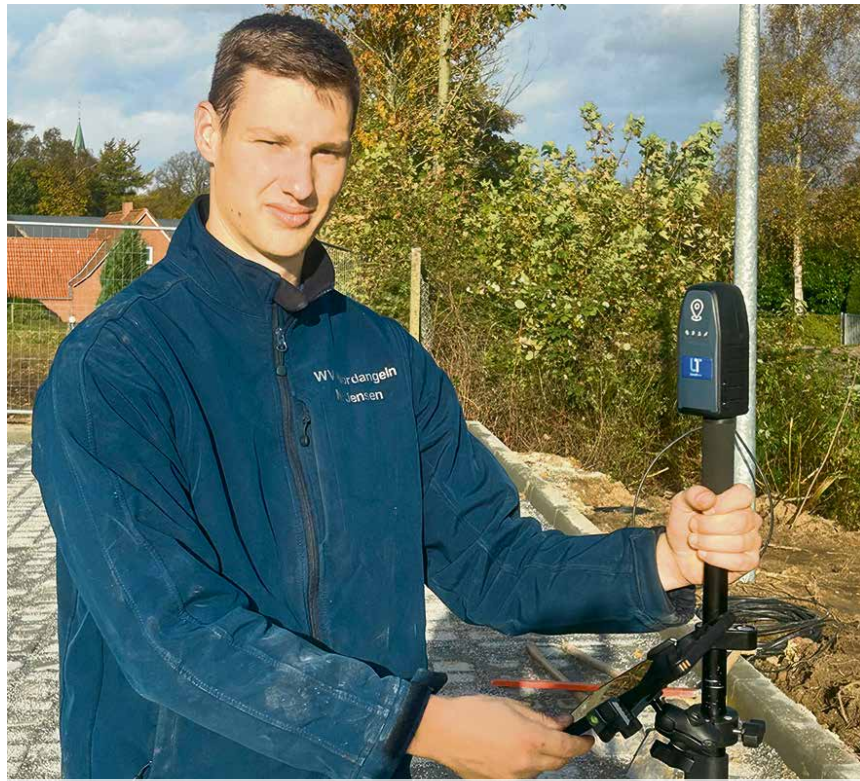
Mit der neuen GPS-Antenne kann Niklas Jensen die genauen Daten von Schiebern, Armaturen sowie Leitungen erfassen und auf kurzem Weg ins digitale System übertragen. Foto: WV
