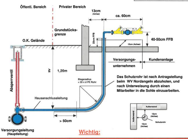
Nicht fachgerechtes bzw. nicht nach Abbildung eingebautes Schutzrohr kann für die Hausanschlussleitung nicht verwendet werden!
